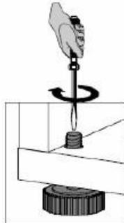
Armarios poseen zapatas niveladoras con reglaje interna.
